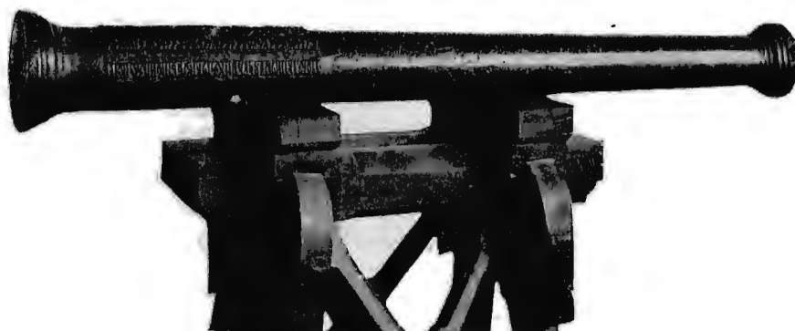
Рис. 42. Памятникъ мѣднаго пушечно-литейнаго мастерства въ Россіи XV вѣка. Длина орудія 54,25 д., вѣсъ 4 п. 26 ф. Калибръ 2,6 дюймъ.
