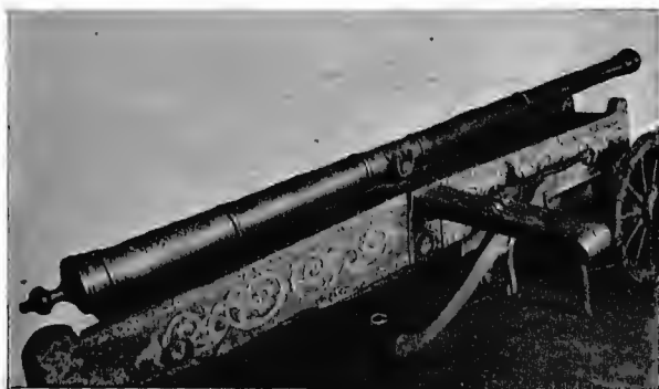
Рис. 55. Пищаль желѣзная XVII вѣка, царствованія Алексѣя Михайловича, длина 207,3 д., вѣсъ 62 п. 30 ф., калибрь 3,6 д.
