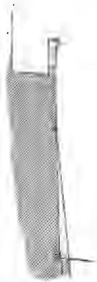
Рис. 92. Разрѣзь стѣны между Троицкой и Комендантской башнями въ другомъ мѣстѣ.
