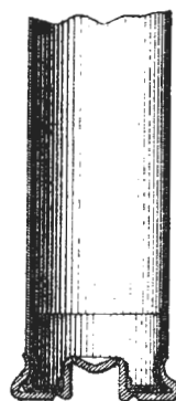
Рис. 78. Составной патронъ съ внутренней чашкой.
